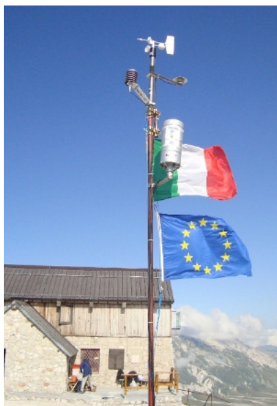
Fig. 1: stazione meteo e analizzatore di Ozono installati nell'ambito del network SHARE a Campo Imperatore (AQ).
